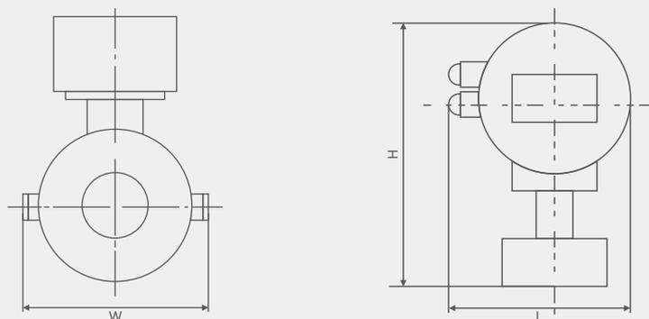
图6夹持型电磁流量传感器外形图
