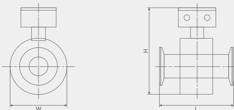
图7卫生型电磁流量传感器外形图
