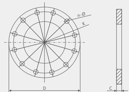
图5连接法兰图
