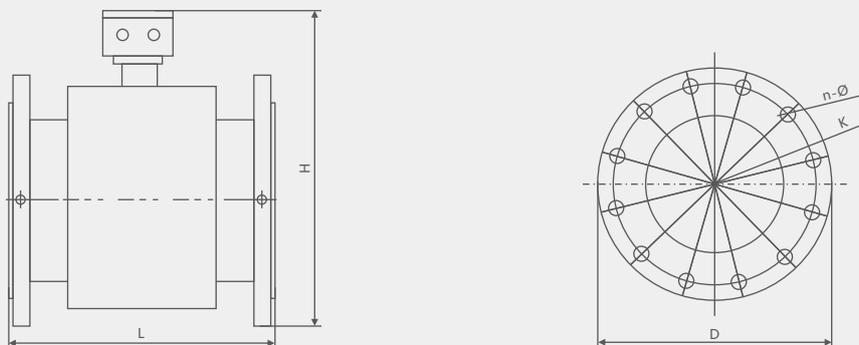
DN6mm~DN3000mm法兰型传感器外型图
